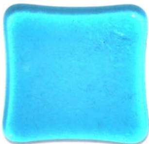
1 Schicht, insgesamt 3 mm Das Glas hat sich nach innen verzogen
