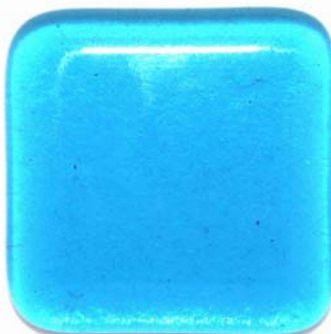
2 Schichten, insgesamt 6 mm Kein Formverlust, sehr schön gerundete Ecken
